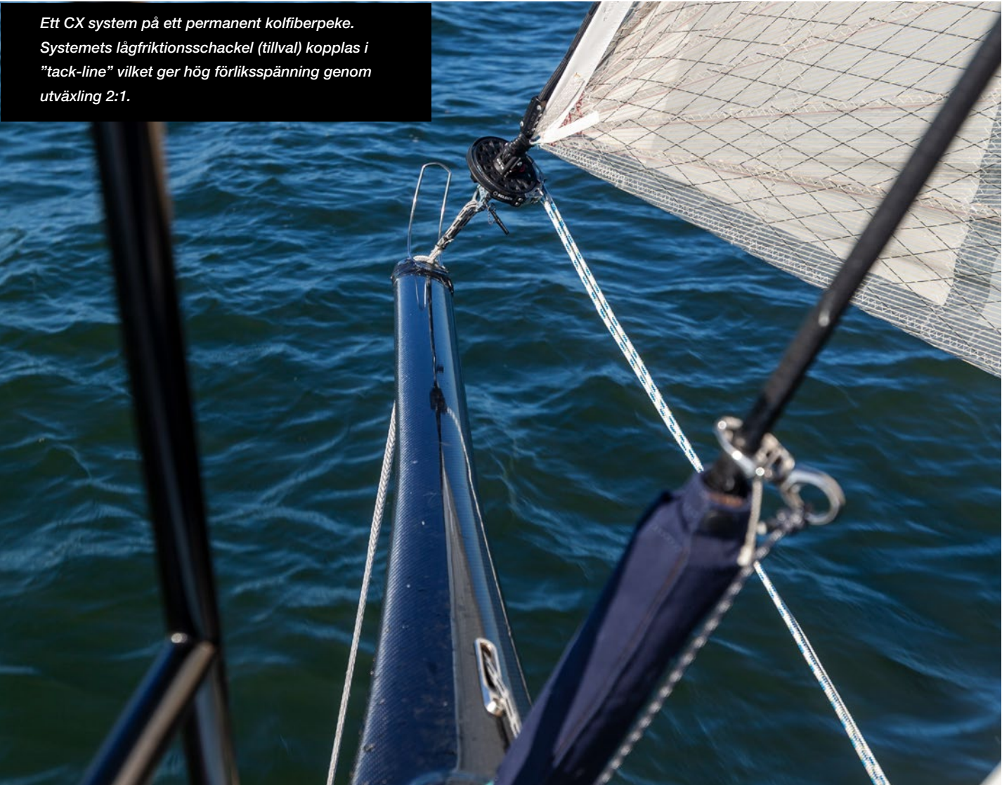
CX15 och ett Race80 peke från Båtsystem, www.batsystem.se . Förlikslasten i en Code 0 är mer än dubbelt så hög än för en gennaker och därför är ett stabilt peke nödvändigt.
